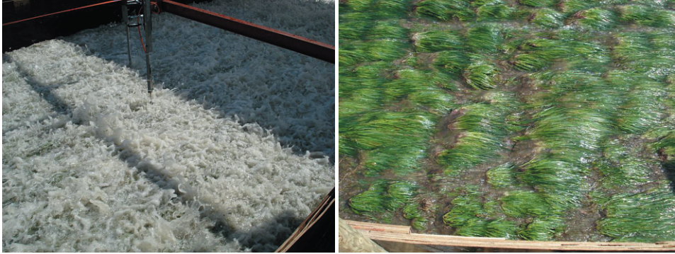
Abb. 1: Kleiabdeckung und Grasnarbe des Deichs in Delfzijl (hier bei 20 l/(s·m) mittlerer Wellenüberlauf rate)
