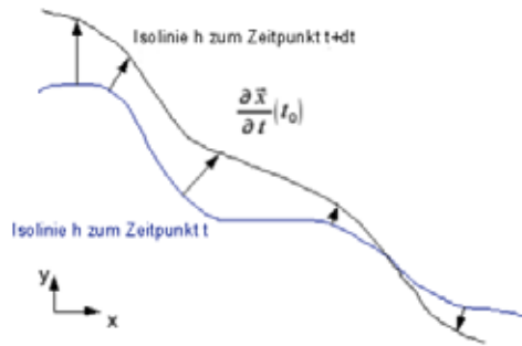
Abb. 22: Isolinienbasierte Bestimmung der morphologischen Geschwindigkeiten
