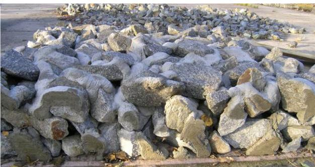
Bild A4-3: Versuchskasten eines sachgerecht hergestelltem teilvergossenem Deckwerks (30 l/m<sup>2</sup>, CP<sub>90/250</sub>, Einbau von Hand)
