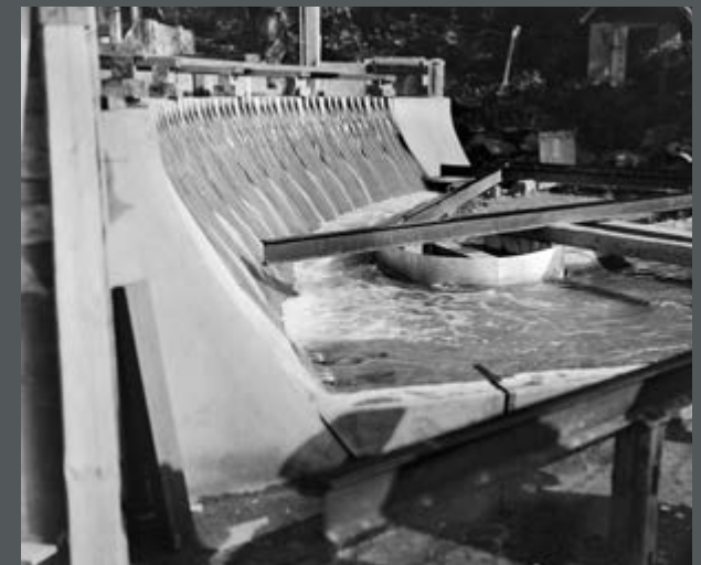
Bild 102: Das hydraulische Modell der Edertalsperre (Maßstab = 1:40) bei simuliertem Hochwasser im Einsatz bei Messungen im Staubecken (im Bereich der untergegangenen Bericher Hütte). (1908)
