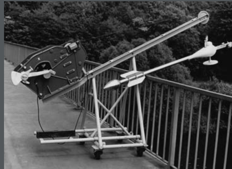
Bild 227: Die Winde „Wolga“ mit Schwimmflügel für Abflussmessungen an der Mosel befindet sich auf einem Fahrgestell. (1955)
