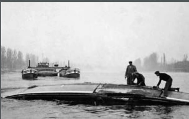
Bild 80: Das auf Grund liegende Motorboot „Kander“ soll mit einer Schiffshebevorrichtung (zwei Boote mit Stahlträger verbunden) aus dem Rhein geborgen werden. (1932)
