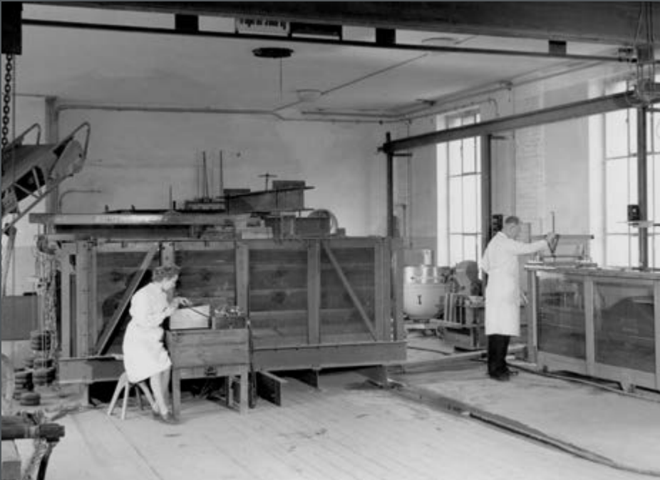
Bild 229: Versuchshalle für Erd- und Grundbau mit Sandkasten und Glasrinne in der BAW. (1955)
