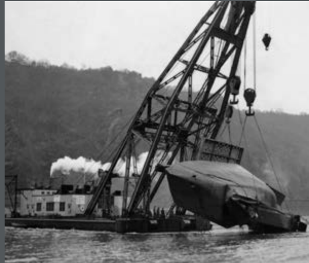
Bild 85: Das im Rhein zwischen Oberwesel und St. Goarshausen gesunkene Motorschiff „MS Friedrich“ wird mit Hilfe des Schwerlastkrans „Gigant“ gehoben. (1959)
