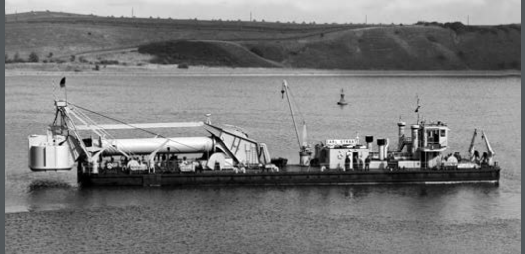
Bild 33: Selbstfahrendes Taucherglockenschiff „Carl Straat“ im Rhein, erbaut 1963. (1968)
