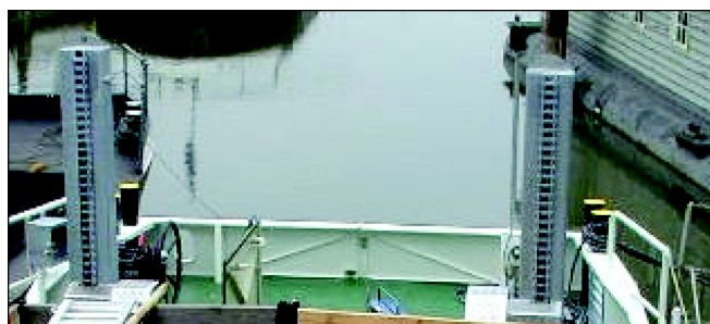
Bild 5: Stelzen bzw. Ankerpfähle
