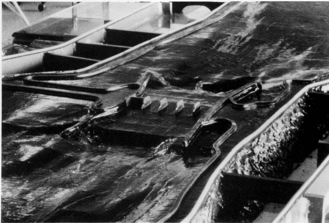
Bild 7: Luftmodell des Eider-Sperrwerks im Maßstab 1 : 1000/500 (Blick von Nordosten)
