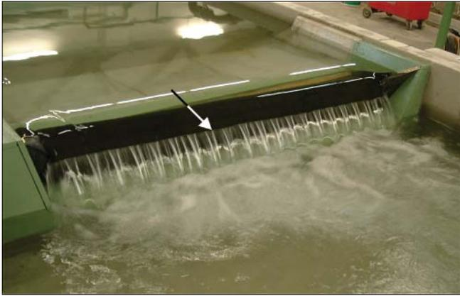
Bild 11: Foto des Schlauchwehrs (vor Einbau der Messtechnik)
