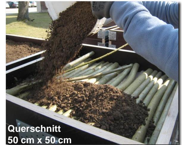
Scherfestigkeitserhöhung des Bodens in Abhängigkeit der Wurzelrockenmasse
