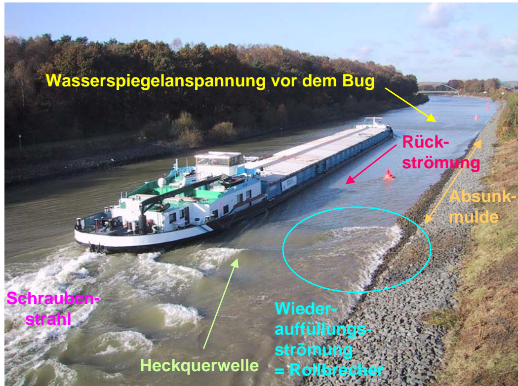
Bild 3.1: Schiffserzeugte Wellen im Wesel-Datteln-Kanal bei der Versuchskampagne im Oktober 2002; hier die ufernahe Fahrt der MS Main bei voller Abladung und einer Geschwindigkeit nahe der kritischen Schiffsgeschwindigkeit
