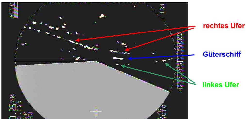
Bild 6.11: Aufnahme des Radarschirms mit Passage eines zu Tal fahrenden Güterschiffes
