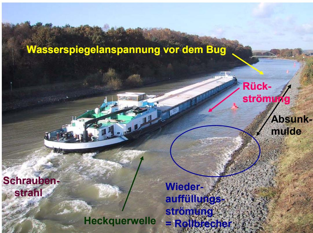
Bild 6.1: Schiffserzeugte Wellen im Wesel-Datteln-Kanal bei einer Versuchskampagne im Oktober 2002; hier die ufernahe Fahrt der MS Main bei voller Abladung und einer Geschwindigkeit nahe der kritischen Schiffsgeschwindigkeit
