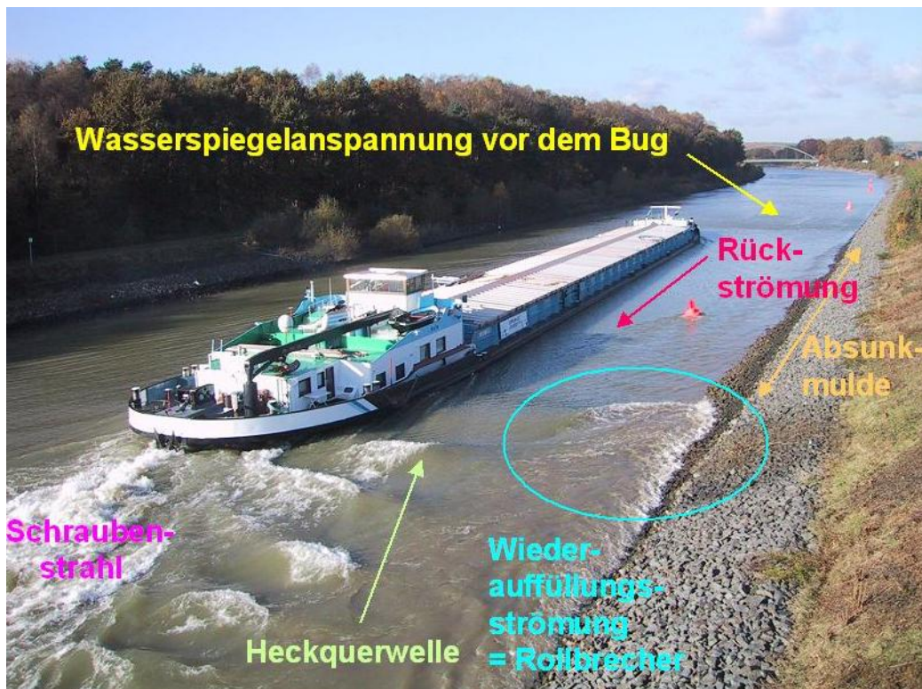
Bild 1: Schiffserzeugte Wellen und Strömungen im Wesel-Datteln-Kanal bei einer Versuchskampagne im Oktober 2002; hier die ufernahe Fahrt der MS Main bei voller Abladung und einer Geschwindigkeit nahe der kritischen Schiffsgeschwindigkeit
