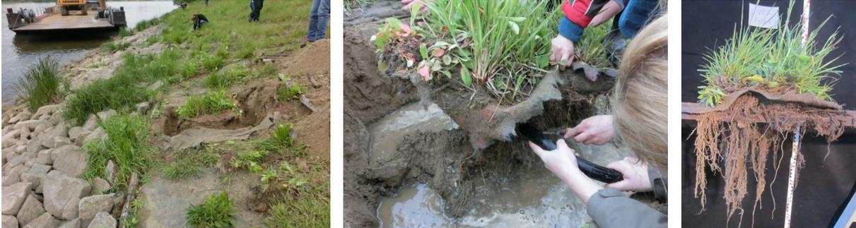
Bild 24: Freispülen der Wurzeln im Untersuchungsfeld U3, rechts: Freigelegte Wurzeln im Untersuchungsfeld U4 (Fotos: BAW)
