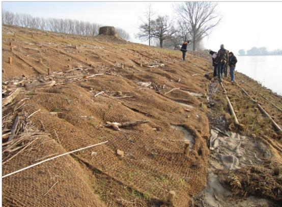
*Bild 26: Böschungsverformungen nach Überstau im VF 7a oben (22.3.2012) (Foto: BAW)*
