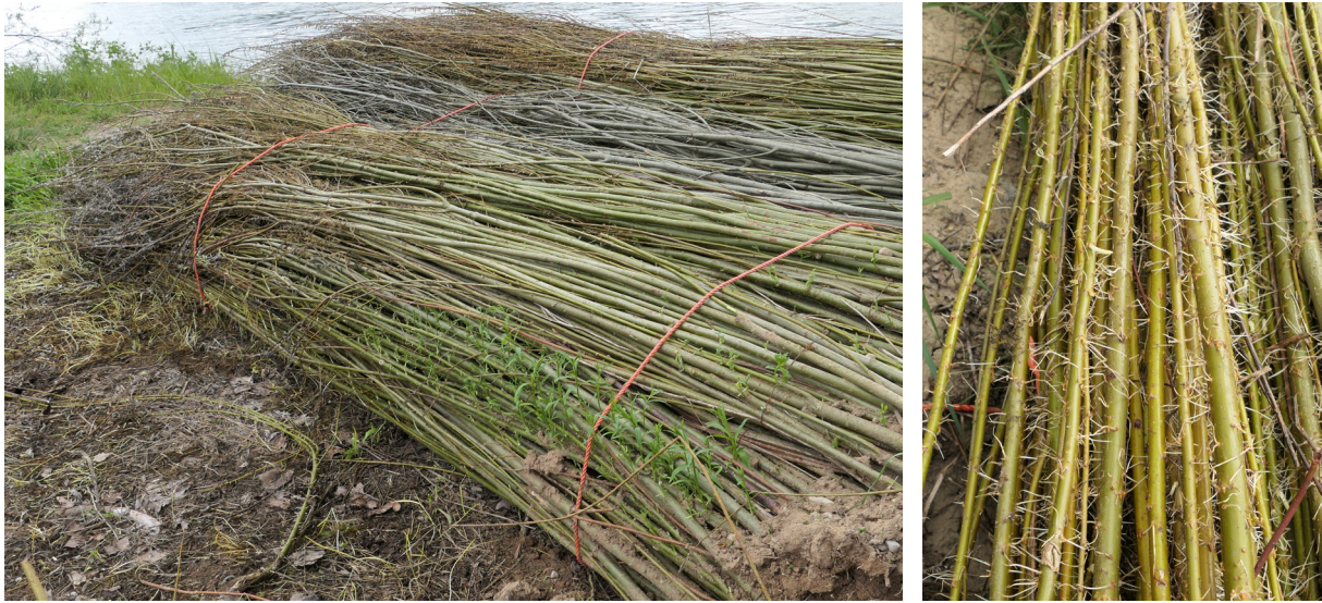
Abbildung 5: Ausgetriebene Weidenäste nach vierwöchiger Lagerung auf der Baustelle am 15.04.2024 (Fotos: BAW).
