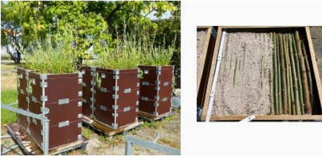
Abb. 4: links: Kasten 1 bis 3 mit Geotextil, Kasten 4 bis 6 ohne Geotextil – 1. Versuchsreihe (23. August 2018, 3 Monate nach Einbau); rechts: Einbauzustand, verlegte Weidenäste, noch unvollständige Übererdung
