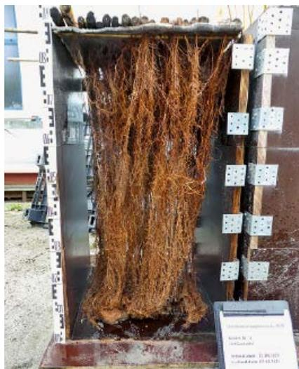
Abb. 5: Freigespülte Wurzeln in Kasten 3 mit Geotextil (3. Versuchsreihe, 2021)
