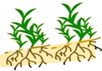
**Gewährleistung der Böschungstabilität durch verzweigtes, tiefreichendes Wurzelsystem**
