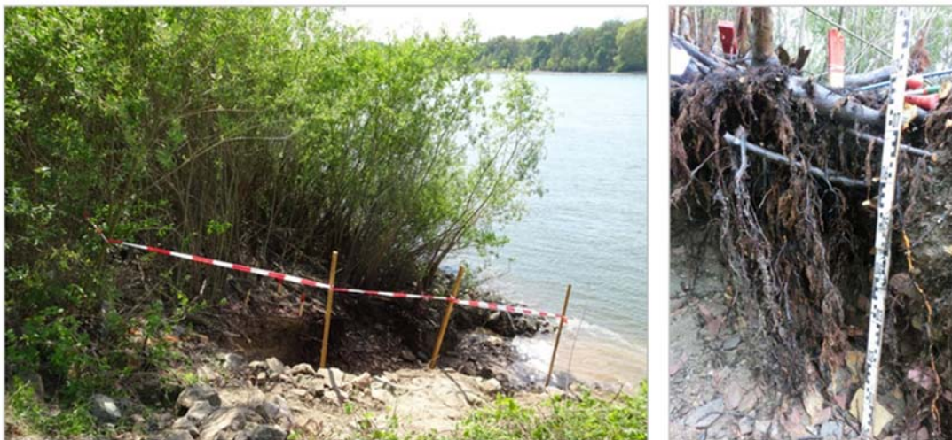
Abb. 3: Wurzelausgrabung im Bereich der Weidenspreitlagen, Rhein-km 440,940
