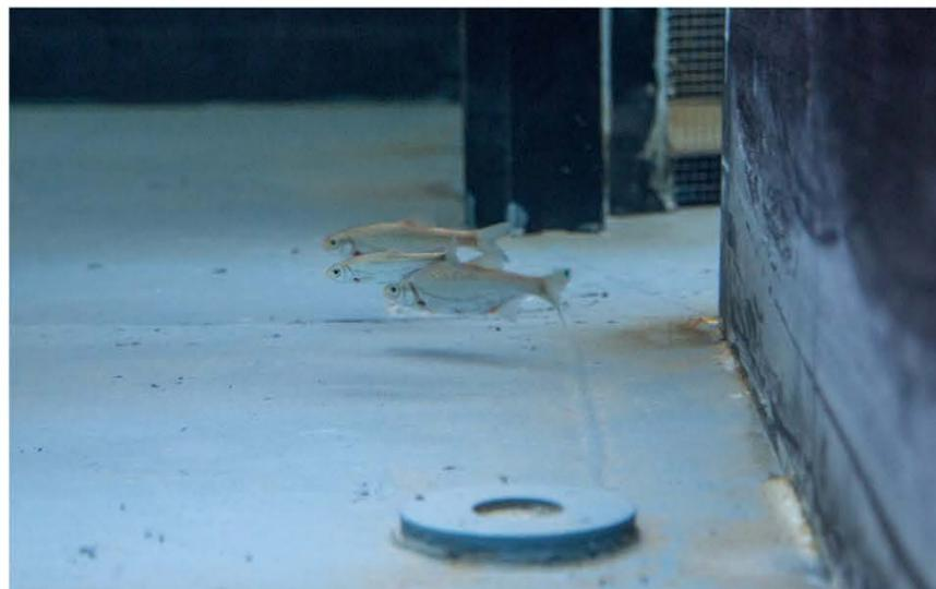
Bild 4: Exemplare der Fischart Schneider nach der Passage des Schlitzes einer FAA im ethohydraulischen Versuch
