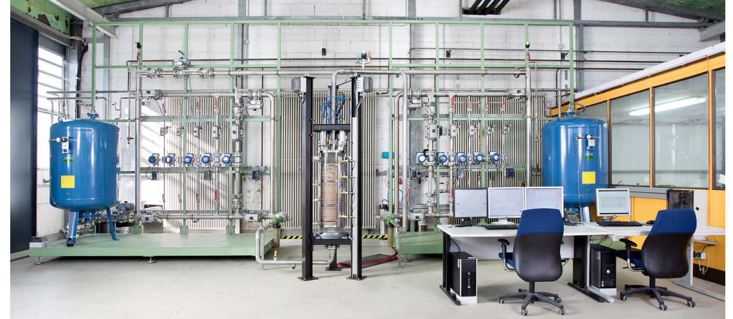
Bild 1: Wechseldurchströmungsanlage der BAW
