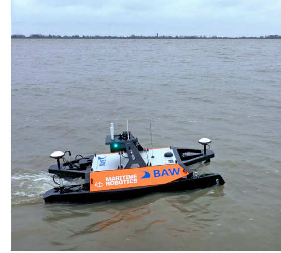
Autonom fahrender Messkatamaran der BAW
