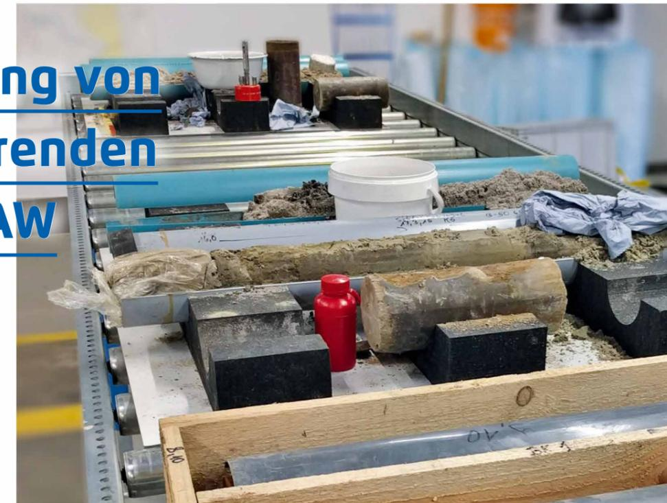
Ausgewählte Bohrkern bei der Bodenansprache
