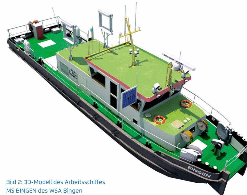
Bild 2: 3D-Modell des Arbeitsschiffes MS BINGEN des WSA Bingen (Modell i. A. der BAW angefertigt von mach:idee (machidee.de))
