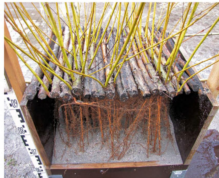
Bild 2: Freigespülte Weidenwurzeln eines Laborversuches
