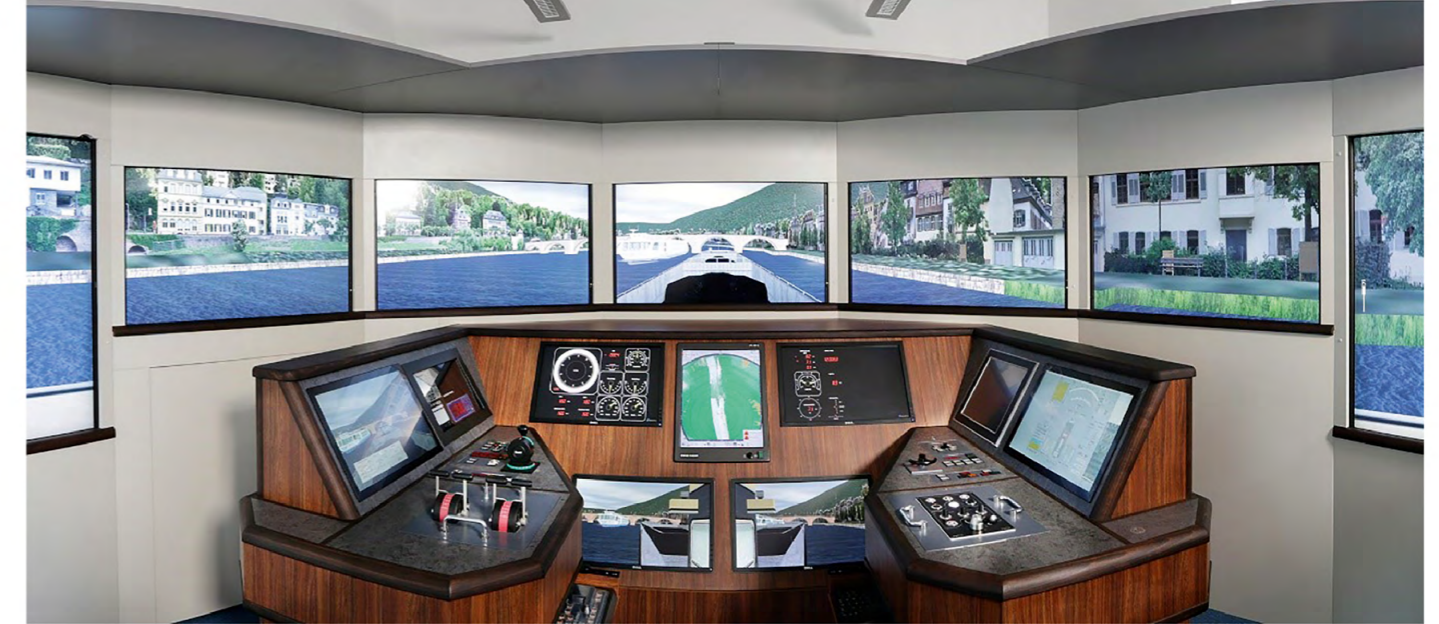
Bild 1: Schiffsführungssimulator ANS 6000 am Standort Karlsruhe der Bundesanstalt für Wasserbau
