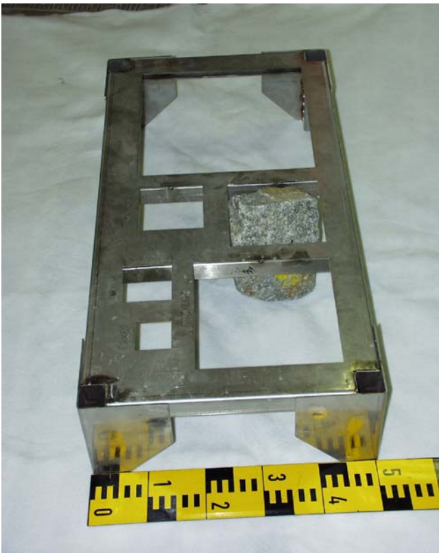
Bild 2: Größenermittlung D über ein Quadratlochsieb
