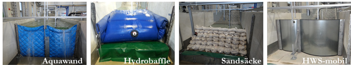
Abbildung 2: Im Labor getestete mobile Hochwasser- bzw. Küstenschutzmaßnahmen.
