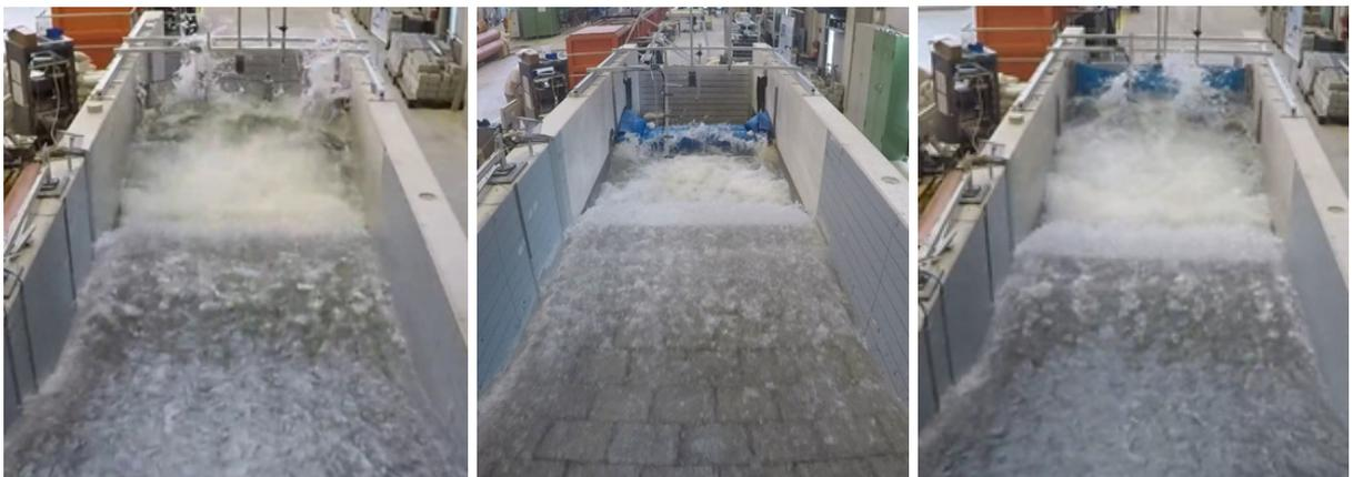
Abbildung 12: Testphase 4 – Wellenanprall auf *HWS-mobil*, *Hydrobaffle* und *Aquawand*.
