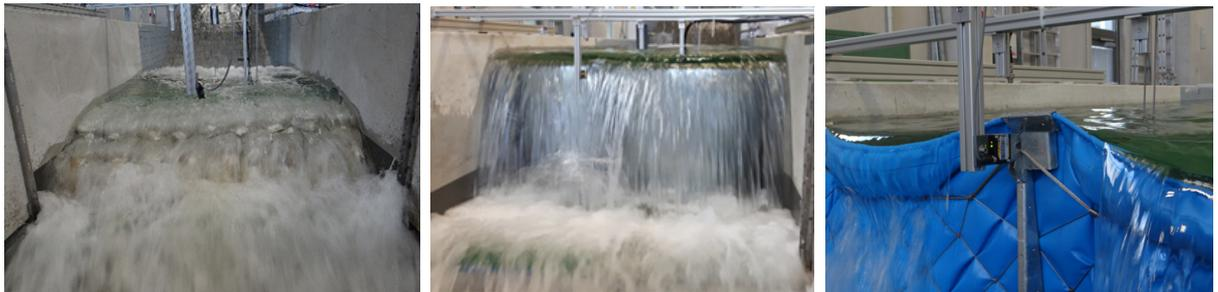
Abbildung 11: Testphase 3 – Überströmen von *Sandsackdeich*, *HWS-mobil* und *Aquawand*.
