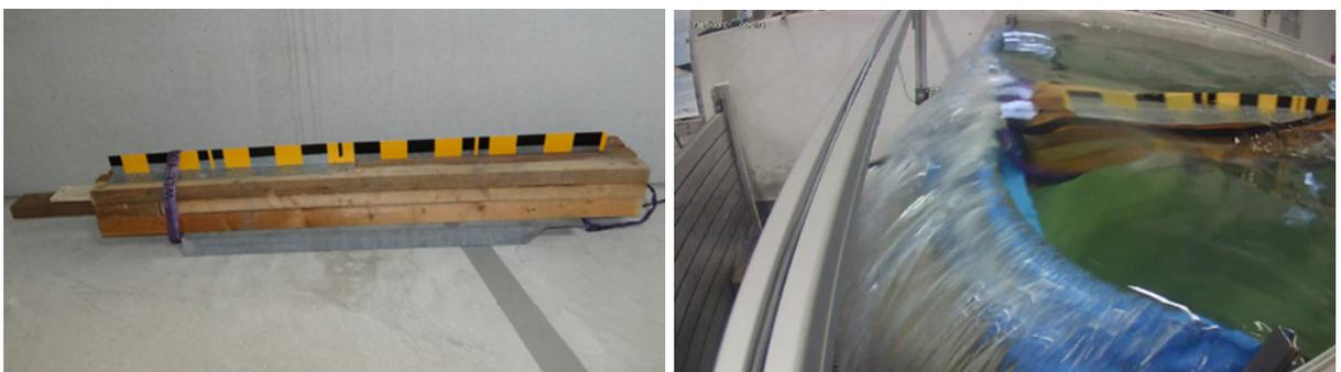
Abbildung 13: Anprallkörper (links) und Anprallversuch an der *Aquawand* (rechts).
