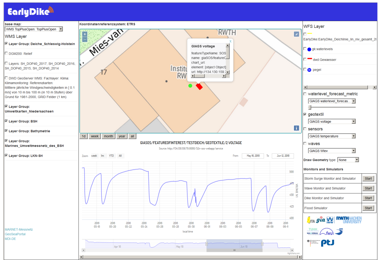
Abbildung 17: Geoportal – Spannungsmesswerte eines Geotextils.
