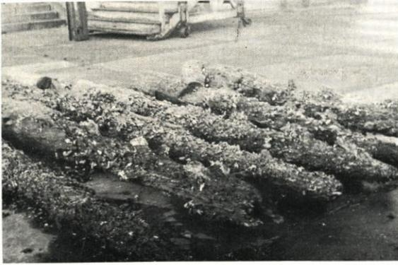
Abb. 22. Die Abbildungen 22 bis 27 zeigen die durch die Bohrmuschel zerstörten Pfähle des Steubenhöfts (Cuxhaven) nach dem Ausbau
