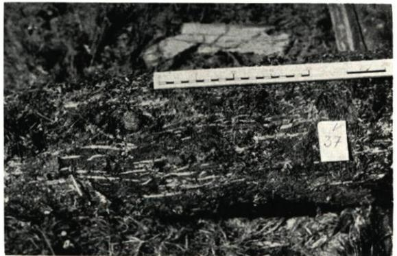
Abb. 39. Unbehandeltes Fichten-Schnittholz, bei dem eine große Anzahl von Kalkgängen freigelegt ist. Die Kalkgänge lagen bis zu 15 cm im Holz und sind von *Chelura* und *Limnoria* freigelegt. Die Hölzer haben nur zwei Jahre ausgelegen
