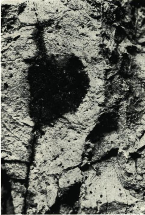
Abb. 25. Tropfpipettmethode Sekeras (Foto etwa 3fach). Der Reflexglanz eines Tropfens, der auf die Bruchfläche trockenen Marschbodens aufgesetzt wurde, verschwindet. Man erkennt, wie der Boden das Wasser aufnimmt
