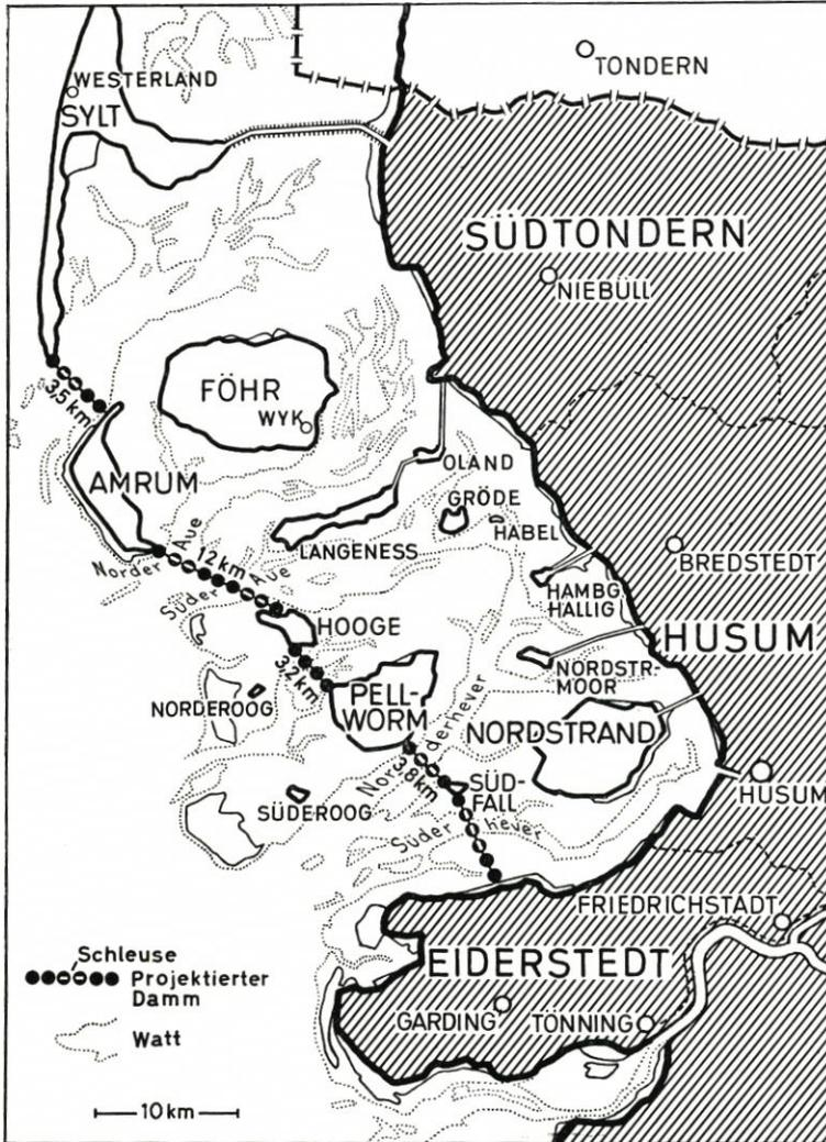
Abb. 9. Der projektierte Damm zwischen der Insel Sylt und Eiderstedt (Dix-Plan)
