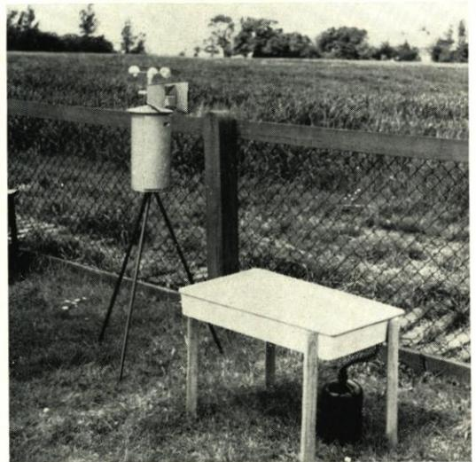
Abb. 2. Auffanggerät für niederschlagschemische Untersuchungen. Im Hintergrund der Windmesser
