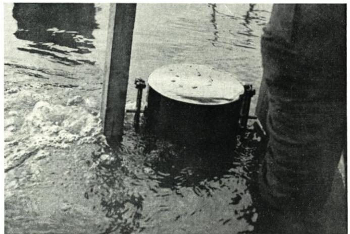
Abb. 8. Der Schwimmer steigt, die Gleitschiene mit der Halte-Öse gibt den Flut-Ast des T-Stückes frei, die Flasche füllt sich nach Entweichen der Luft (Blasen an der Wasseroberfläche links)
