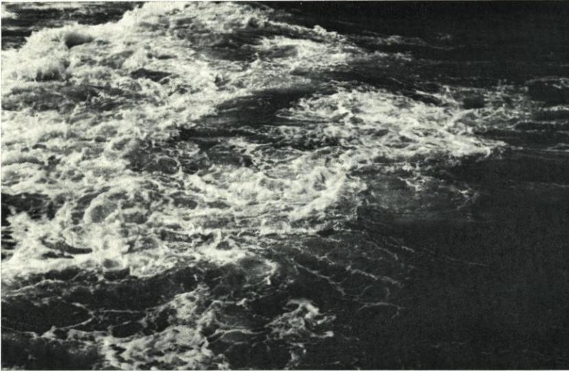
Abb. 4. Wasserspiegelunruhe beim Austreten der Blasen aus dem Wasser
