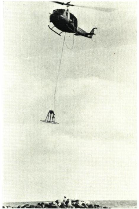
Abb. 8. Transport des Vibro-Geräts zur Probenentnahmestelle
