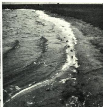
Abb. 2 (a-f). Modellversuch mit Sichelbuhne im Strandsee a. Fehmarn
