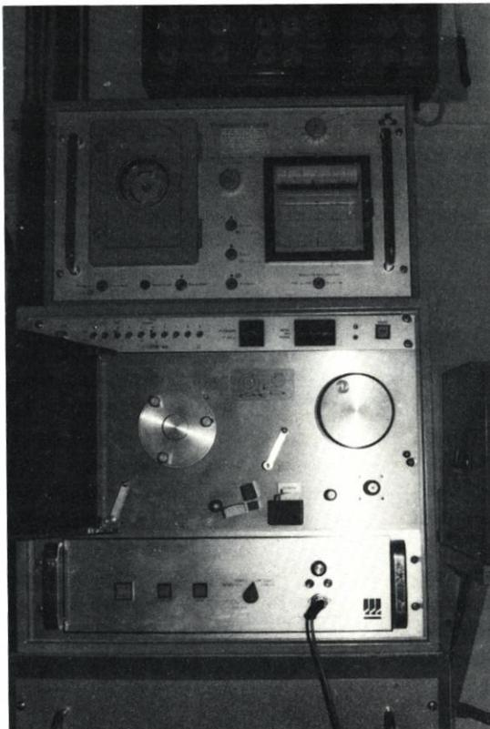
Abb. 3.5 Empfangsstation mit AD-Wandler und Magnetbandgerät
