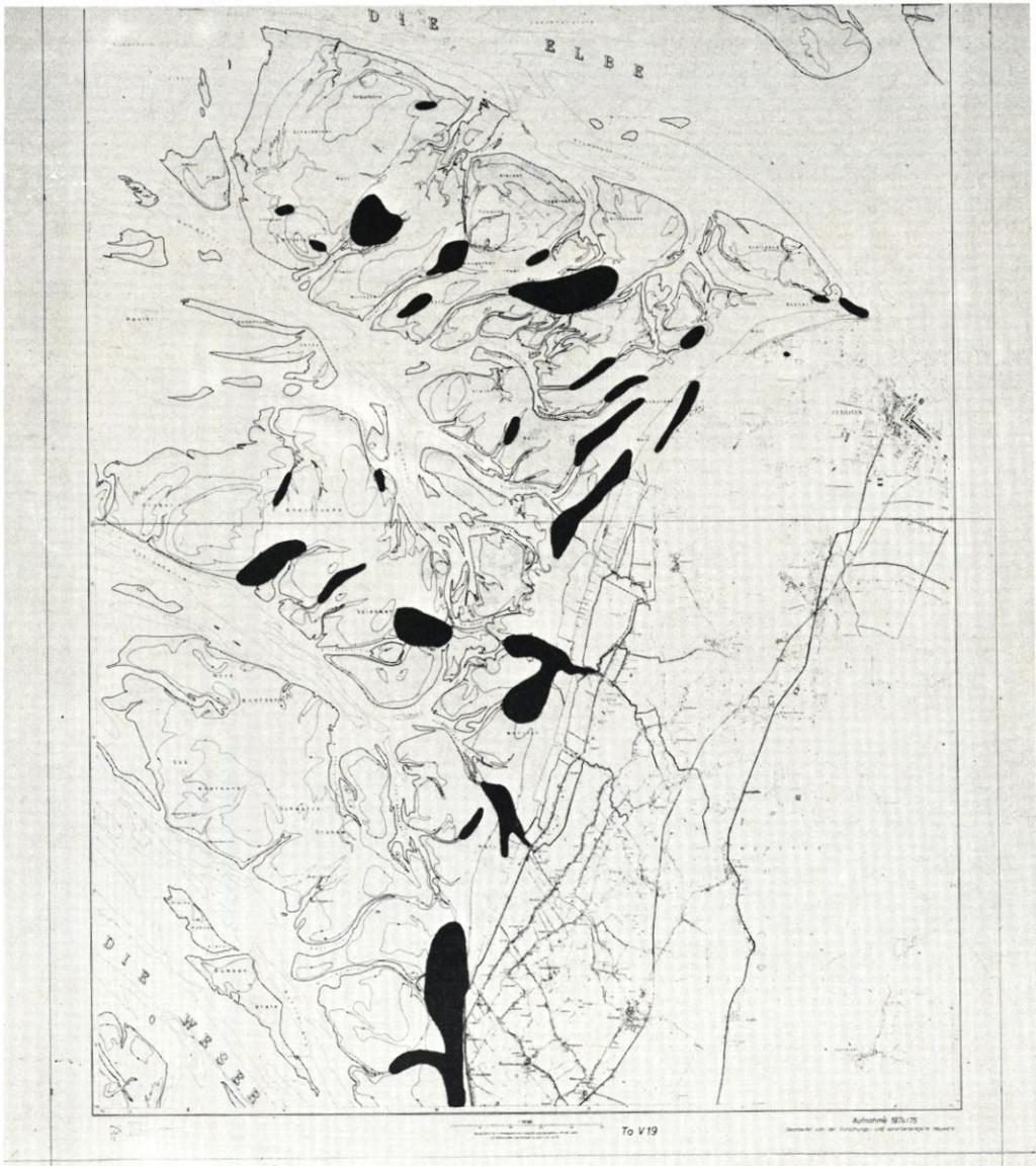
Abb. 2. Wurster und Cuxhavener Küste mit Gebieten, in denen nach sinnlicher Wahrnehmung Schlick und anschlückiger Sand zu finden sind
