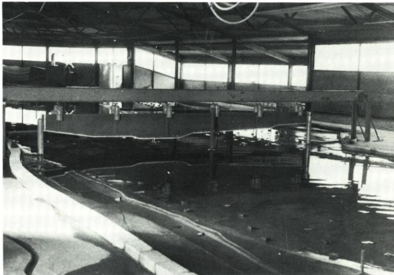
Abb. 10. Sperrwerk bei Bielenberg im Modell, Ansicht von der Seeseite
