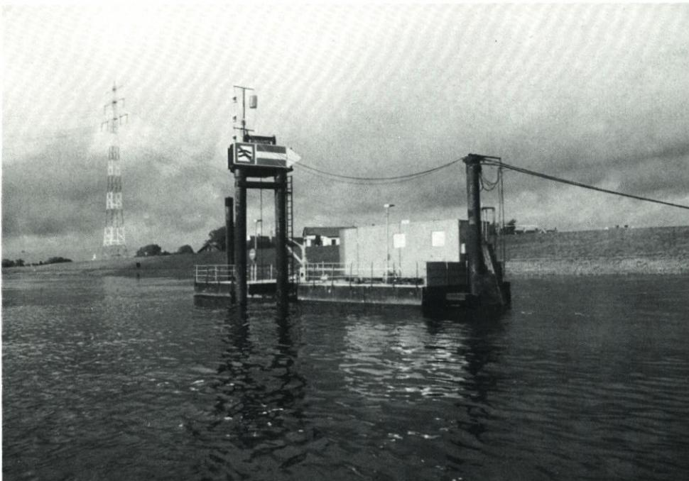
Abb. 2. Pontonanlage mit der Meßstation Oortkaten (AMO). Dem Ponton vorgelagert sind zwei Pfähle, zwischen denen der Geräteträger geführt wird
