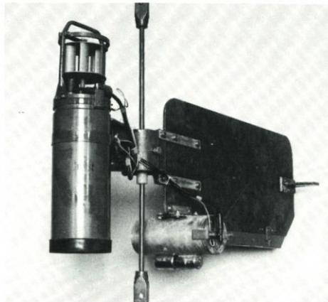
Abb. 5. Attenuationsmeßgerät des IfMB, gekoppelt an das Strömungsmessgerät von Aanderaa. Die Meßstrecke wird durch die Fahne quer zur Strömungsrichtung gestellt
