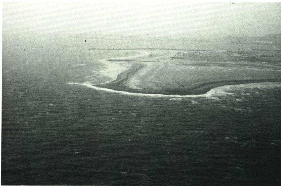
Abb. 35. Beginnende Lee-Erosion östlich des Endes der Landebahn (Aufnahme vom 24. 2. 1984, 10.00 h, bei MTnw)
