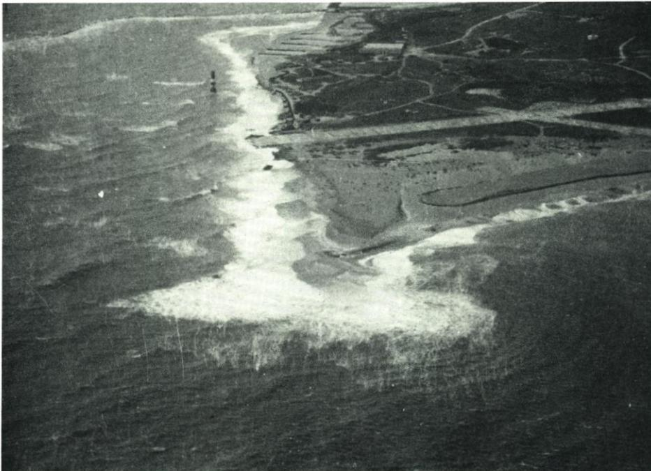
Abb. 17. Wellenrefraktion und -diffraktion am Südstrand (mit Tetrapodendam im Hintergrund) und an der Aade am 19. 11. 1982 (Foto: Singer, Helgoland)
