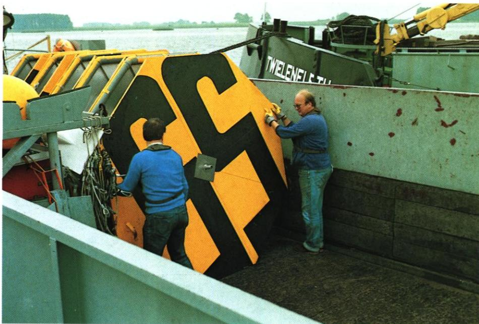
Abb. 3: Auf dem Weg zum Einsatzort erfolgt der „Massen“-Transport von zerlegten Schwimmern in einer Schute
