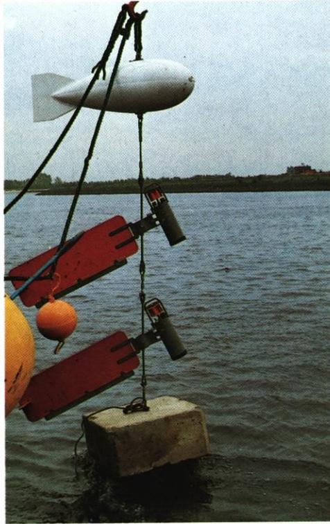
Abb. 12: Strömungsmessgeräte in einer Auslegekette
