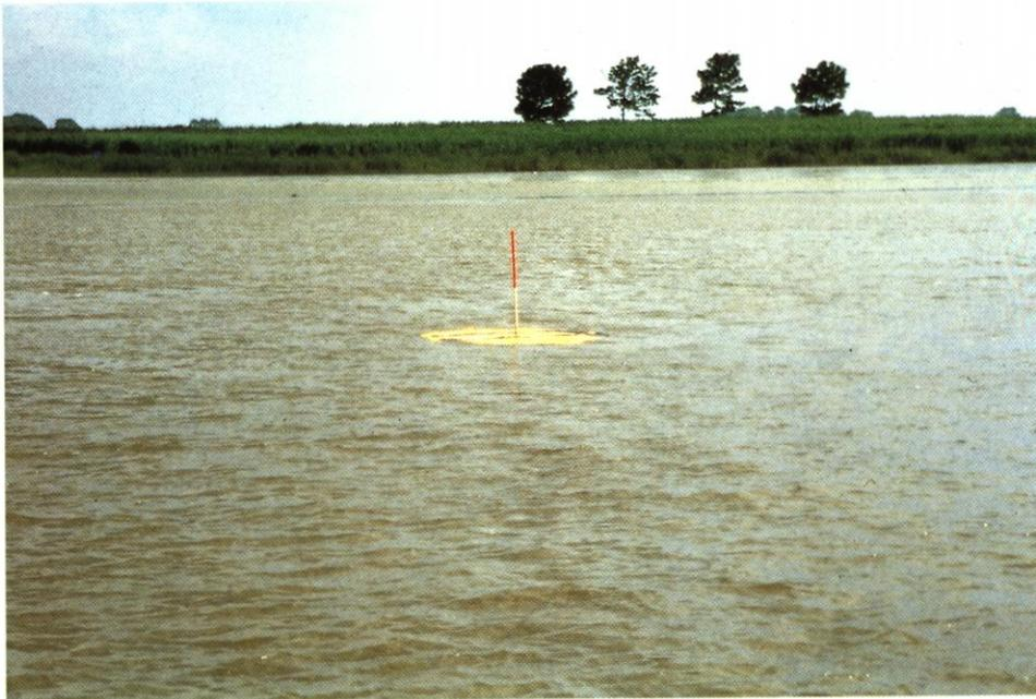
Abb. 2: Ein Schwimmer im Bereich der landseitigen Umströmung der Brammerbank. Deutlich erkennbar die absolute Planlage des Treibkörpers, der die Wasseroberfläche so gut wie gar nicht überragt und deshalb keinerlei Luftwiderstand bzw. Windangriffsfläche bietet
