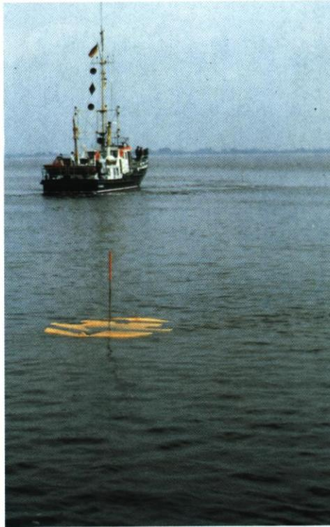
Abb. 5: Begleitende Positionsbestimmung eines Schwimmers vom Schiff aus (Einzelmessung)
