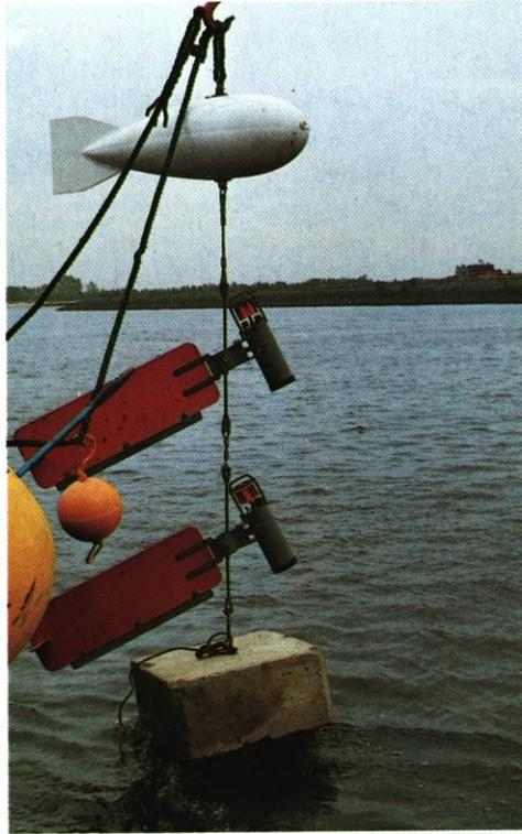
Abb. 12: Strömungsmessgeräte in einer Auslegekette
