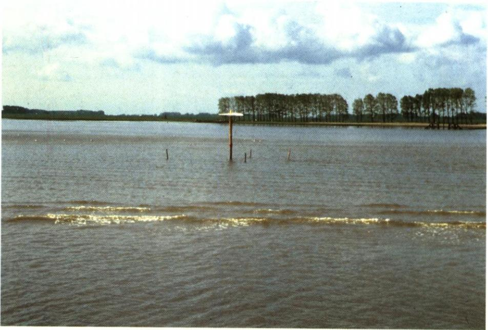
Abb. 6: Die Entzerrung der Luftbilder und die Kartierung der Schwimmer war durch die im Arbeitsgebiet mehrfach gesetzten Markierungspunkte möglich. Der weißlackierte Top des Festpunktes besitzt einen Durchmesser von 2 m
