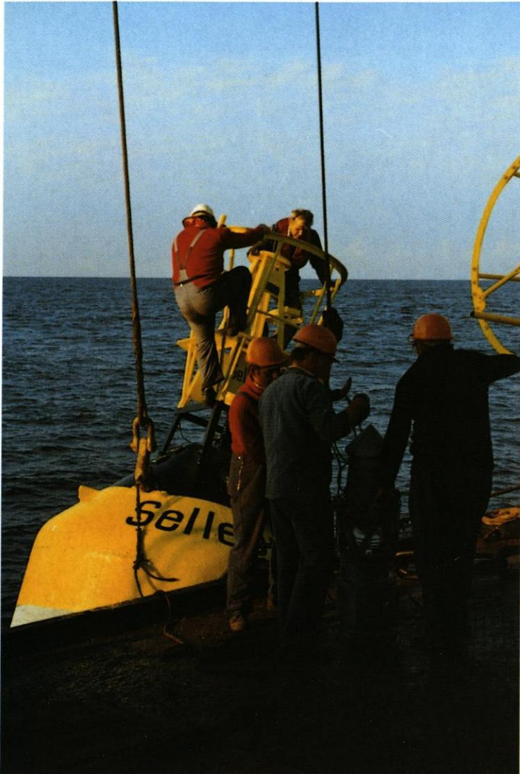
Abb. 23: Tonnenarbeiten vor Helgoland. Vom Seezeichenschiff „Kapitän Meyer“ wird eine neue „Sellebrunn“ ausgelegt
