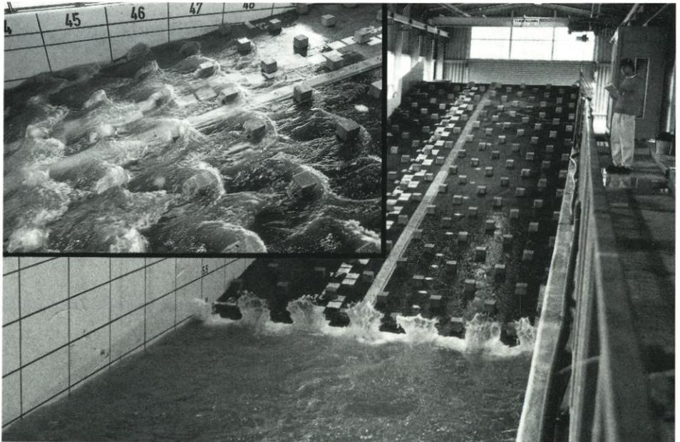
Abb. 26: Böschung  $\tan \alpha = 1 : 6$  mit Betonblöcken unter Wellenbelastung
