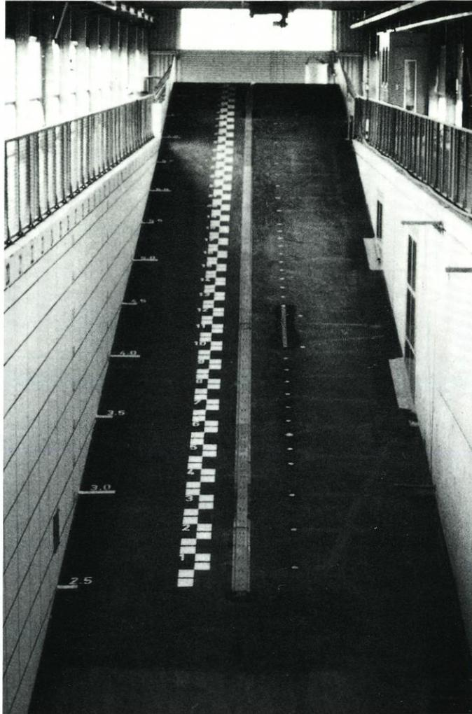
Abb. 6: Asphaltbetonböschung mit der Neigung  $\tan \alpha = 1:6$  mit Wellenauflaufpegel und Meßraster
