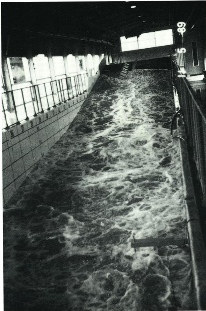
Abb. 12: Asphaltbetonböschung mit  $\tan \alpha = 1 : 6$  unter Wellenbelastung
