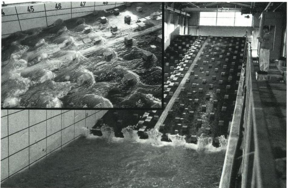
Abb. 26: Böschung  $\tan \alpha = 1 : 6$  mit Betonblöcken unter Wellenbelastung
