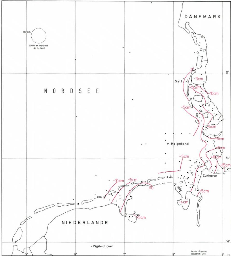
Abb. 3. Linien gleicher MTmw (bezogen auf NN, Lassen, 1989)
