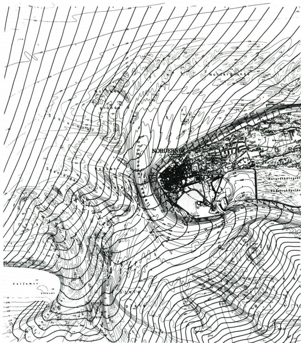
Abb. 4: Seegangsausbreitung im Bereich des Norderneyer Seegats (Windrichtung: West; Wasserstand MThw)
