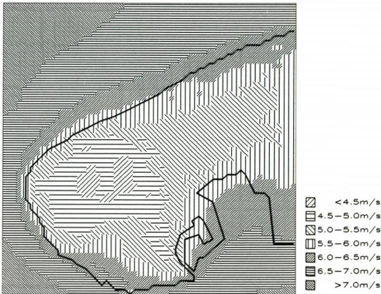
Abb. 6: Klimatologische Mittelwerte (1982–1991) der Windgeschwindigkeit über dem Westkopf c Norderney in 10 m Höhe aus Modellrechnungen.
