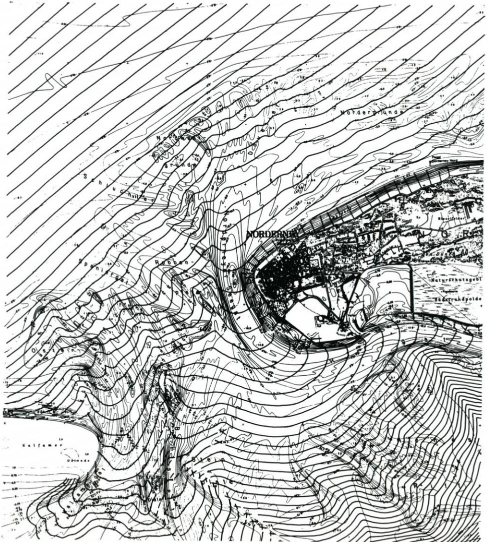
Abb. 5: Seegangsausbreitung im Bereich des Norderneyer Seegats (Windrichtung: Nordwest; Wasserstand MThw)
