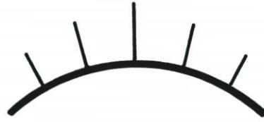
fächerförmige Anordnung mit unterschiedlich langen Buhnen
