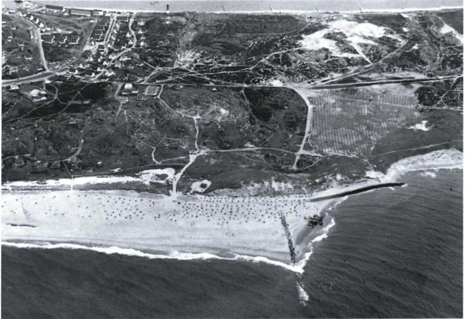
Abb. F 11. Wirkung einer langen Buhne aus Tetrapoden vor Hörnum auf Sylt – Auflandung auf der Luvseite und Erosion auf der Leeseite
