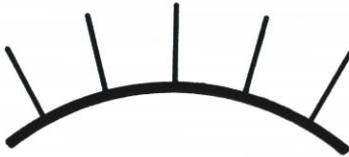
fächerförmige Anordnung mit gleichlangen Buhnen
