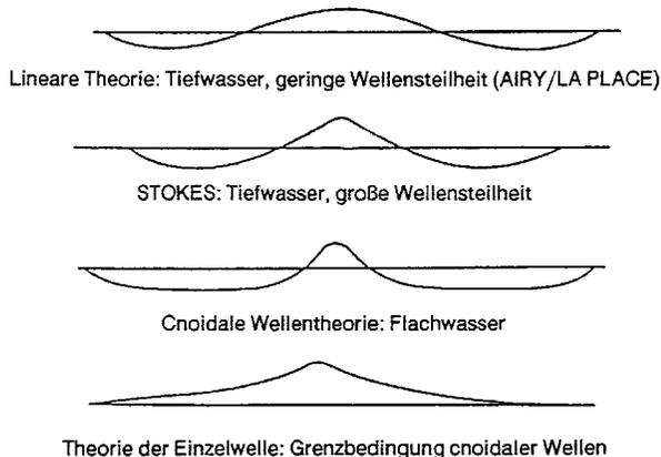
Abb. A 3.4: Zur Anwendung von Wellentheorien (aus LE MEHAUTE, 1976)
