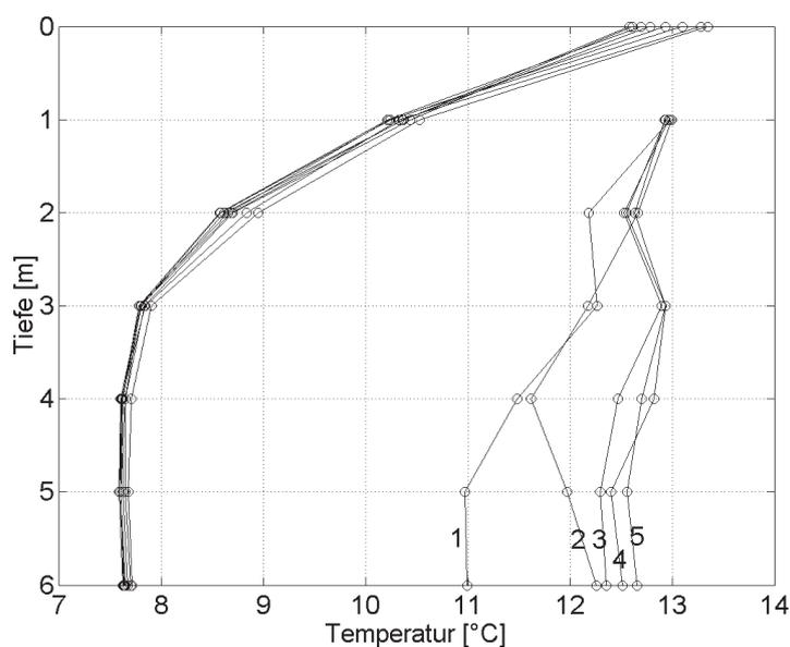
Abb. 11: Vergleichende Darstellung der Temperatur-Tiefen-Profile beider Stationen
