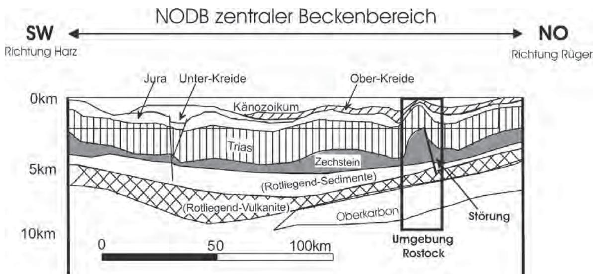
Abb. 13: Geologischer Schnitt durch das Nordostdeutsche Becken (WOLFGRAMM, 2002)
