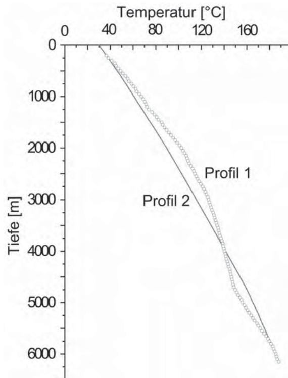
Abb. 2: Temperaturprofil der Tiefbohrung Parchim 1/68 (LOTZ und FÖRSTER, 2002)
