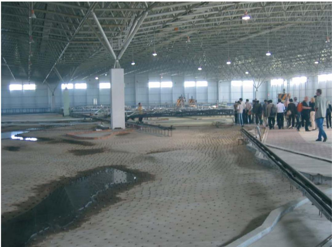
Abb. 7: Besuch des ECSRC und Besichtigung des Modells zur Untersuchung von Strombaumaßnahmen im Mündungsbereich des Yangtze
