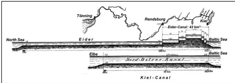
Fig. 2: Comparison Eider Canal / Kiel Canal (after BESEKE, 1893)
