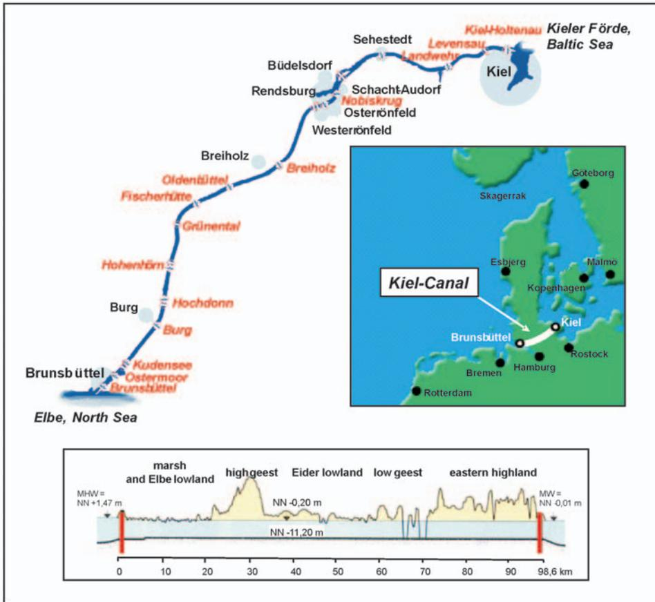
Fig. 1: The Kiel Canal (KIEL-CANAL, 2008; TAG NOK, 2008; WSA BRUNSÜTTEL, 2008a and WSA KIEL-HOLTENAU, 2008)
